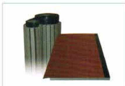
*Lastra o rotolo in polistirene espanso sinterizzato con aggiunta di grafite accoppiato a membrana bituminosa ardesiata, poliesteri o velovetro con cimosa di sormonto su due lati nella lastra.*
